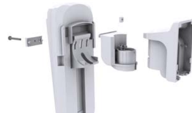
Figure 4 : Vue éclatée du support pivotant
