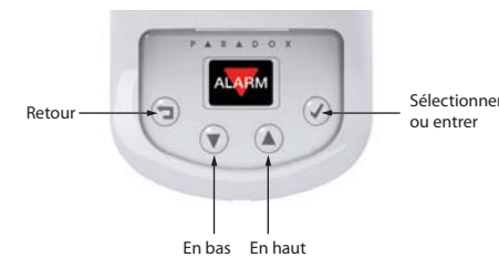
Figure 5 : Écran OLED et boutons du NVX80
